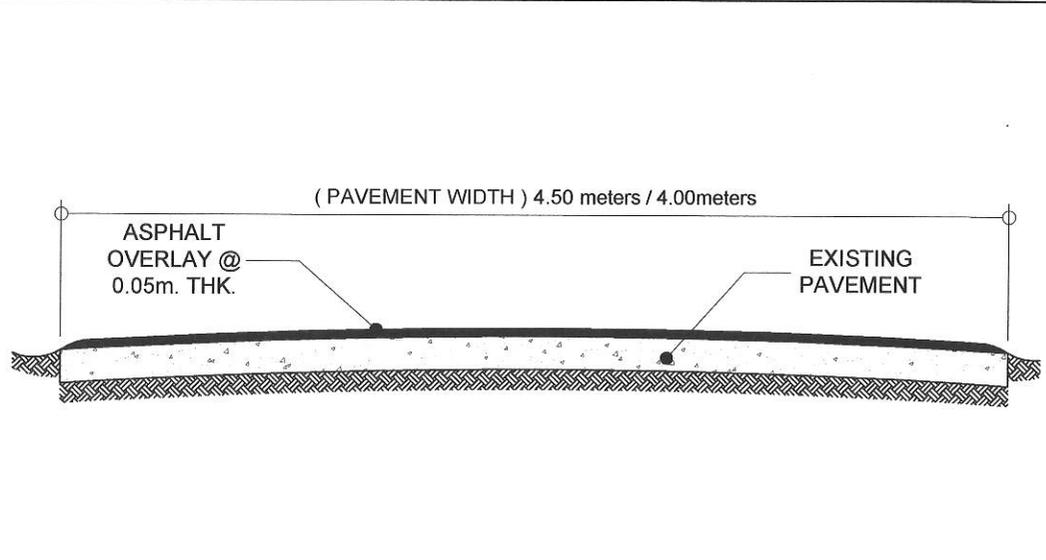
**2** CROSS SECTION OF ASPHALT OVERLAY AT STA. 0+025 - (W=8.50m.) DAY CARE AREA TO STA. 0+042 - (W= 4.50m.) NTS.
