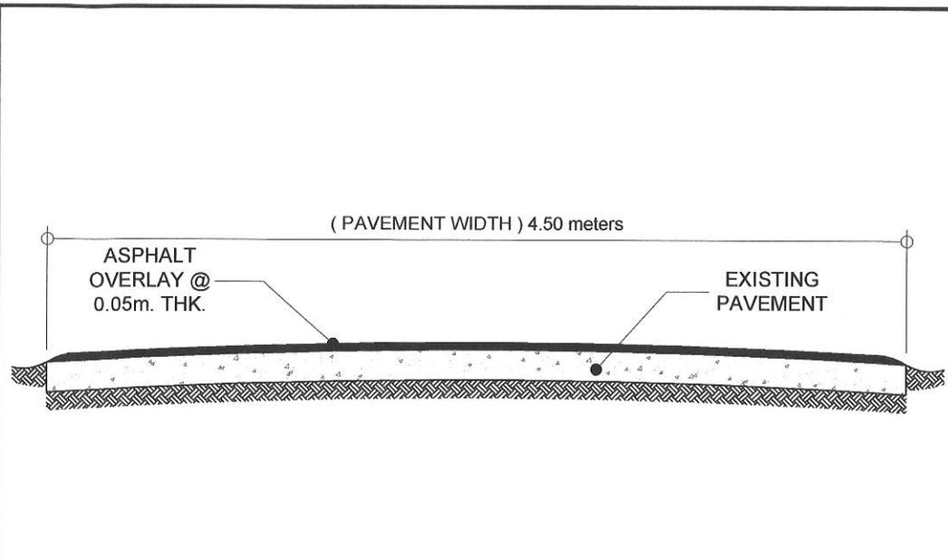
**1** CROSS SECTION OF ASPHALT OVERLAY AT STA. 0+000 - (W=8.50m.) DAY CARE AREA TO STA. 0+025 - (W=3.00m.) NTS.
