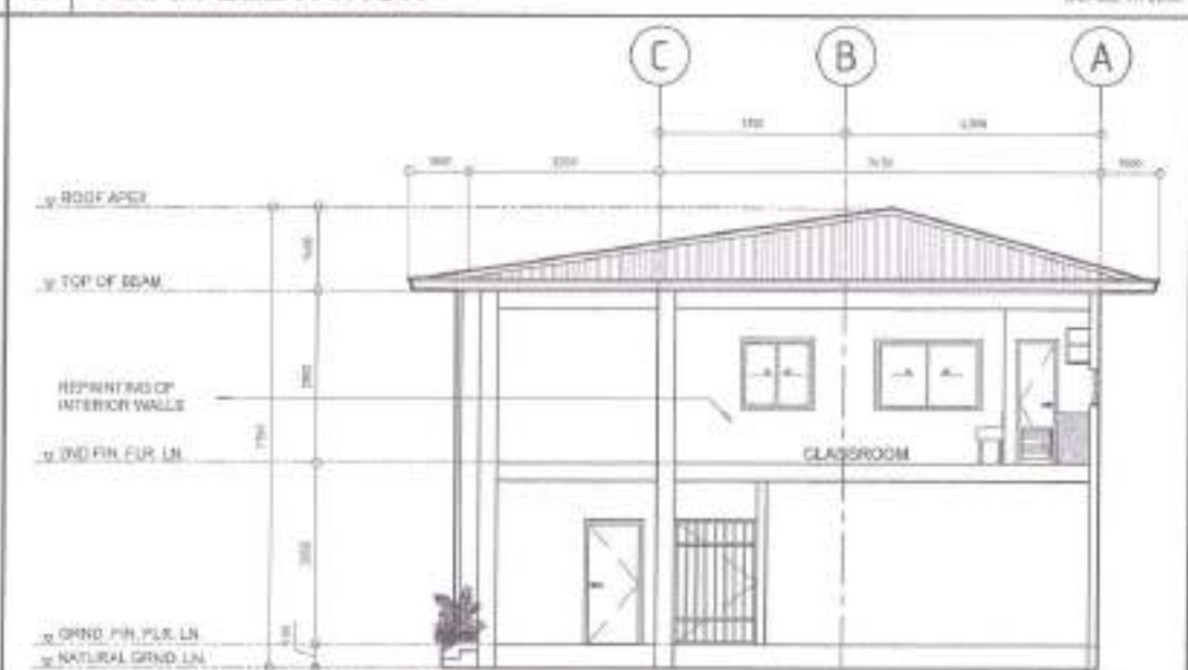
4 LONGITUDINAL SECTION THRU-A
